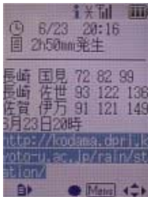
図 - 7 iモード携帯電話に着信した豪雨発生通知メールの例
