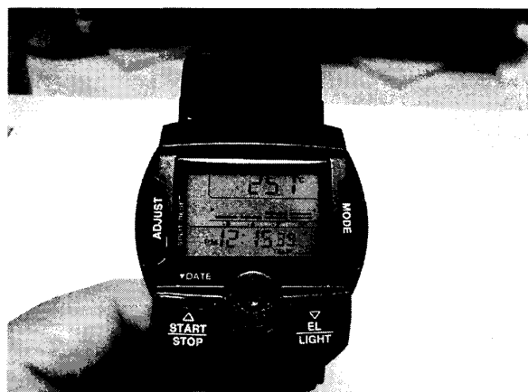
写真5-3 0.1℃単位で表示されたデジタル温度計 エンベックス気象計(株)の「フィールド・メッセⅢ」。上欄が温度(気温)で、25.1℃と表示されている。仕様書によると温度計の精度は0～40℃の範囲で±1℃とのこと。
