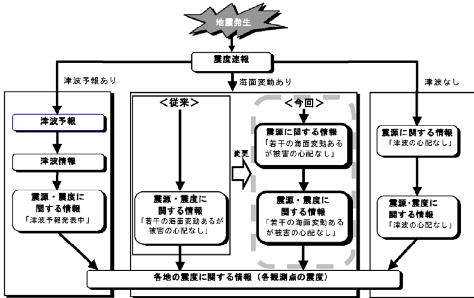
図 8.4 震度 3 以上の地震発生時における情報発表の流れ(気象庁, 2003 より引用)
